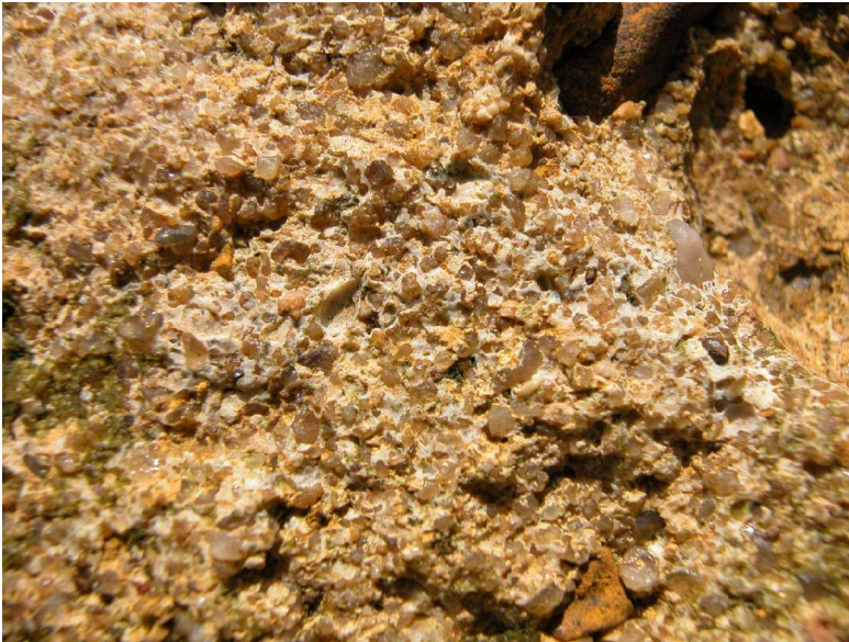
Abb. 4: Nahaufnahme der mit Calcit zementierten, quarz-sandigen Grundmasse.
